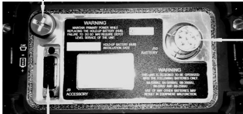
Рисунок 2.14 – Кришка гнізда для заміни батареї (HUB) (зворотній бік радіостанції)
