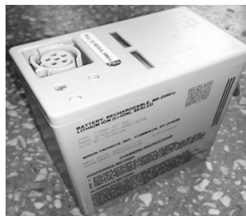
Рисунок 1.4 – Акумуляторна батарея ВВ-2590/У Li-ION
