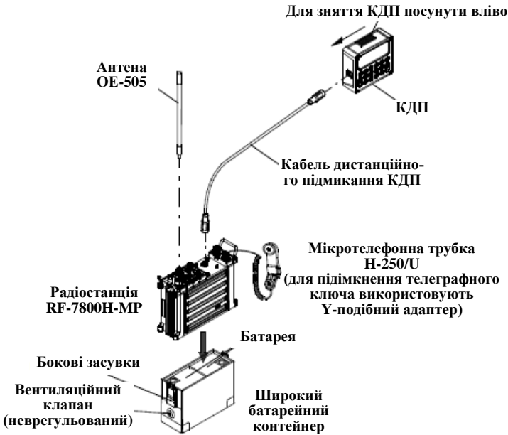
Рисунок 2.18. – Порядок збирання й розбирання переносної радіостанції RF-7800H-MP
