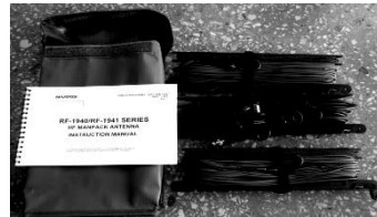
Рисунок 1.8 – Диполь- антена RF-1940-AT001
