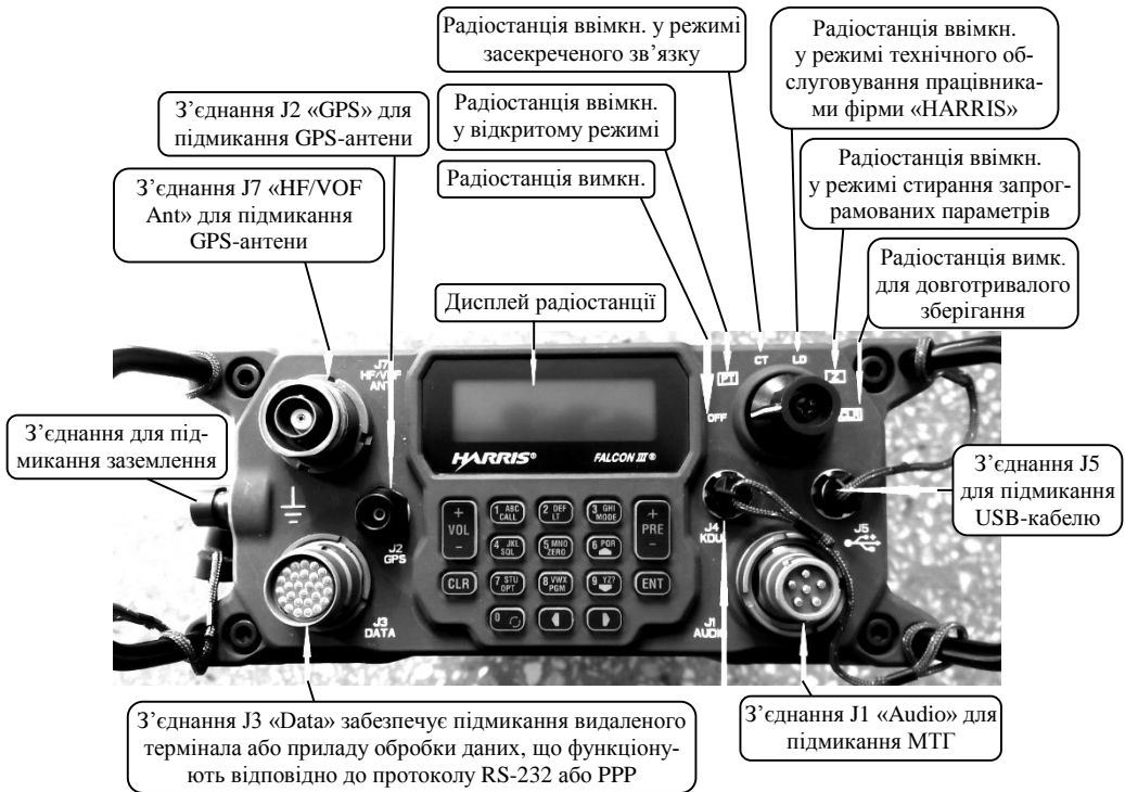
Рисунок 1.14 – Призначення перемикачів і з'єднань на передній панелі радіостанції
